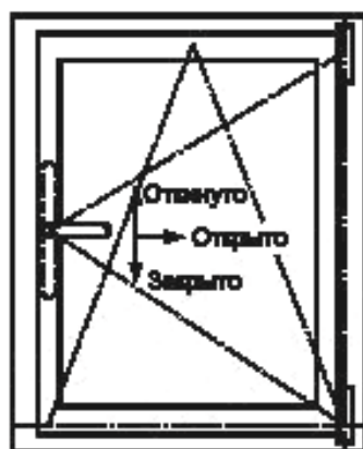
Рисунок А.3 — Поворотно-откидное устройство
